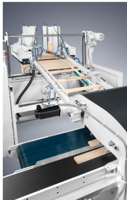
Des imprimantes à jet d'encre ou d'étiquettes sont utilisées pour l'identification explicite des pièces après la coupe.
